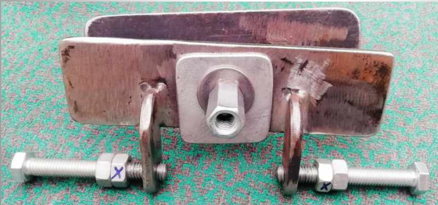
Centírozáshoz készítettem egy ilyen szerszámot, a villára kell felfogatni.
